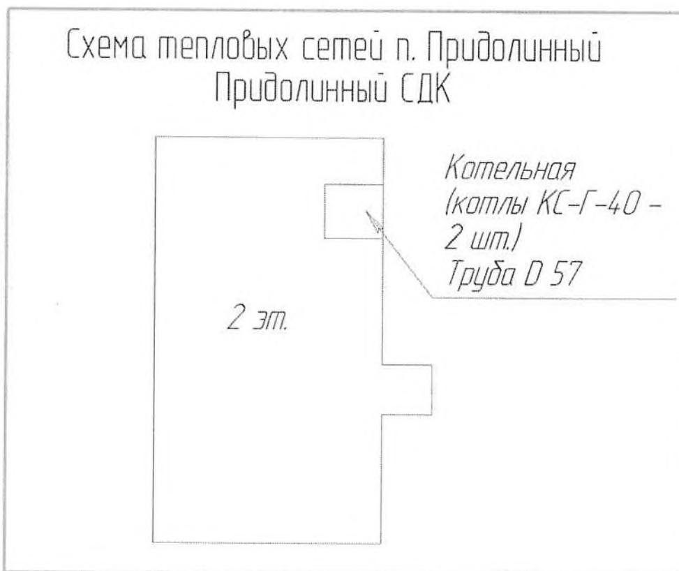
Рисунок 4.4 – Схема теплоснабжения Придолинный СДК
